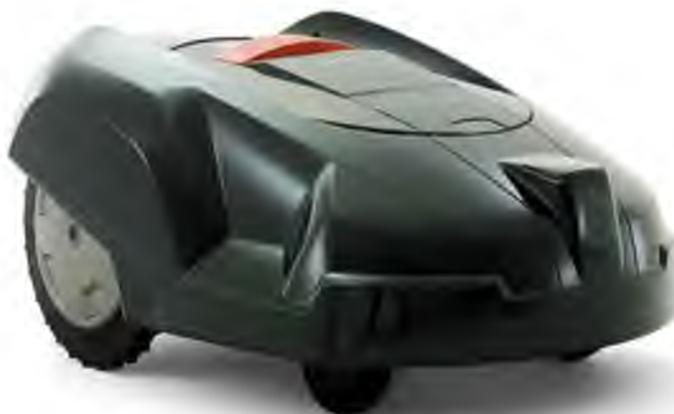
Tunde gazonul în modele aleatorii, tăind iarba frecvent, în timp ce firele mici de iarba revin în gazon, pentru a forma fertilizatorul. Este acționată de o baterie, iar o barieră electronică o menține acolo unde se dorește.
